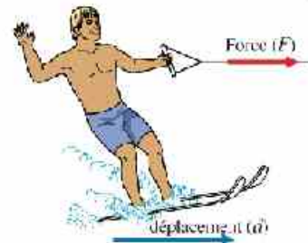
Fig. (3): Le travail fourni sur le sportif est calculé en multipliant le déplacement ( d ) par la force ( F ) agissant dans le même sens du mouvement.
